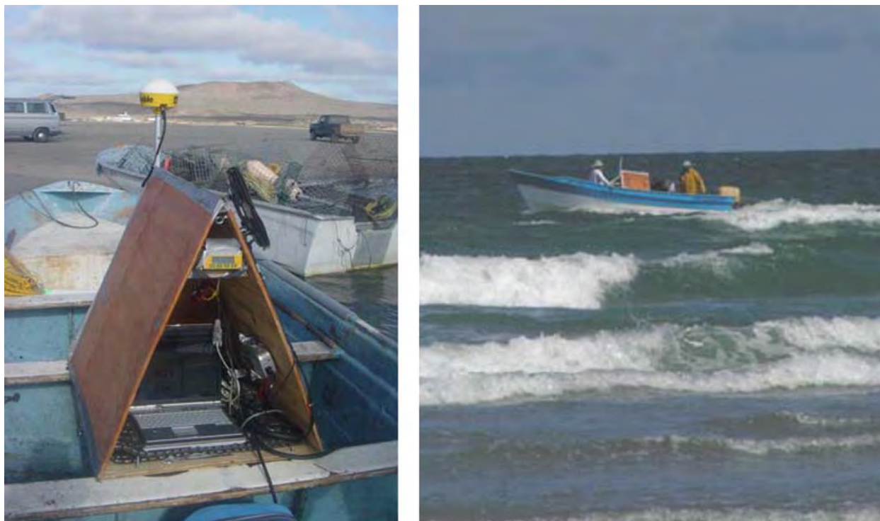
Figura 6. El equipo sensor remoto se adecuó a una panga, con la cual se realizaron los transectos en la rompiente de olas.
